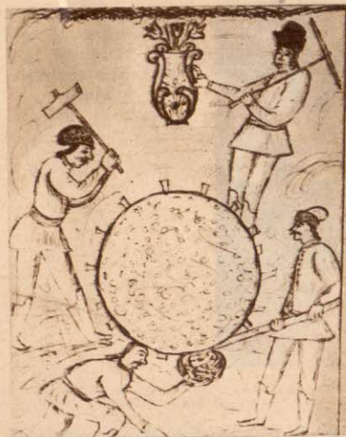
Malomkőkészítés a XVIII. században. Rajz a sárospataki malomkőbányász-céh 1768. évi jegyzőkönyvéből
