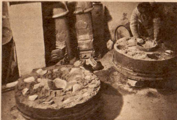
A tetejézés művelete során a malomkő felső részét cementbe ágyazott kődarabokkal kibélelik
